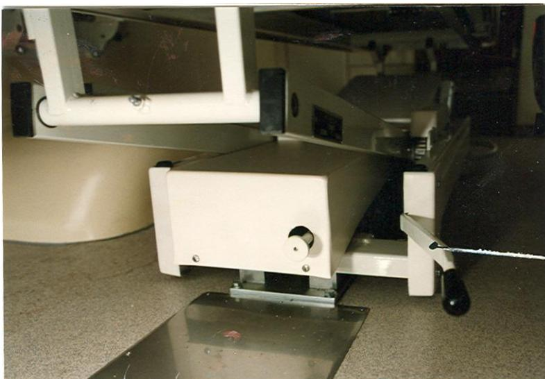
**Zum seitlichen Verschieben des gesamten Tisches ist der vordere Fußbügel bzw. der hintere Hebel 4 zu betätigen. Auf sicheres Einrasten des Tisches in der jeweiligen Position ist zu achten!**
