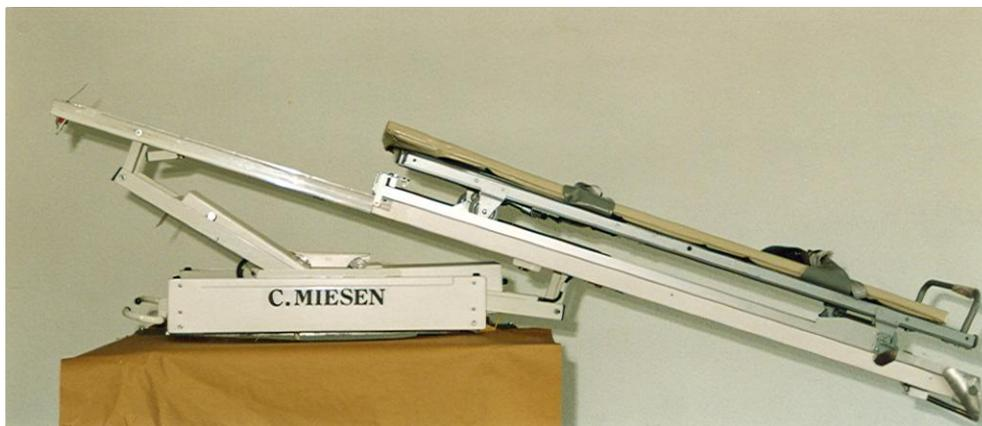
**Zum Anheben des Bühnenendes Schalter 3 so lange drücken, bis die Bühne eine waagerechte Position erreicht hat. Das Anheben des Bühnenendes kann jederzeit durch Loslassen des Schalters 3 unterbrochen werden. Bühne einschieben, nachdem sie durch Drücken des Hebels 1 entriegelt wurde. Auf sicheres Einrasten der Bühne achten.**
