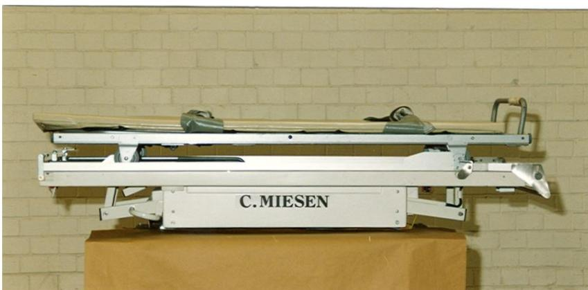
Zum Heben und Senken der Bühne "Auf" - und "Ab"- Schalter drücken. Die Auf- bzw. Abfahrt kann jederzeit durch Loslassen des Schalters unterbrochen werden. Hinweis: Soll die Bühne zum Ein- bzw. Ausladen der Trage abgesenkt werden, so ist der "Ab"- Schalter so lange zu betätigen, bis die "Ab"- Leuchte erlischt.
