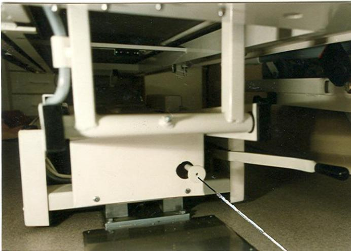
Am hinteren Ende unten befindet sich das Notablassventil. Bei Ausfall des Aggregates bzw. der Elektrik zum Entladen der Trage den Notablassknopf vorsichtig nur wenig öffnen (Linksdrehung) und bei Beginn des Absenkens sofort loslassen.
