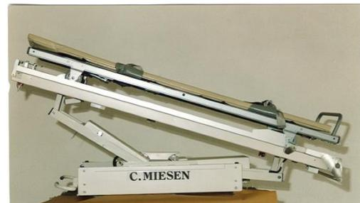
Am die Bühne in Kopf- bzw. Fußtieflage zu bringen, ist der entsprechende Schalter zu betätigen. Die Kopf- bzw. Fußtieflage kann aus jeder Position der Bühne angefahren werden. Die waagerechte Position wird durch Drücken der entsprechenden "Mitte"- Taste angefahren. Diese muss so lange gedrückt werden, bis die Bühne die gewünschte Position erreicht hat.
