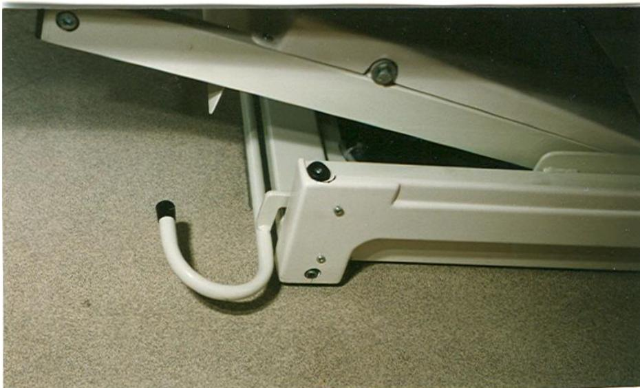
**An der Stirnseite befindet sich der Fußbügel für die Querverschiebungsentriegelung.**
