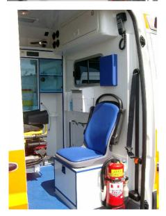
Un regard dans la cabine arrière nous montre la facilité du chargement d'une chaise portoir par un plateau en acier inoxydable ou d'un brancard sur sa table, qui peut être équipée d'une suspension pneumatique en option.
