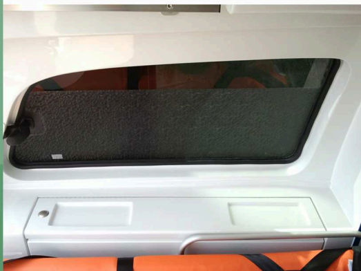
Vakuummatratzenschrank an linker Seitenwand Cabinet for a vacuum mattress on left sidewall
