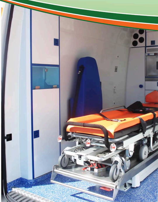
Sauerstoff-Schrank an linker Seitenwand Cabinet for oxygen flask on left sidewall
