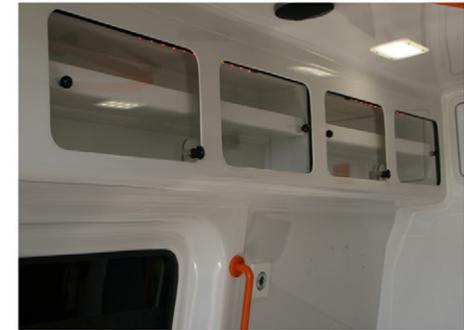
**Im unteren Bereich der Trennwand ist die Sauerstoffflasche liegend untergebracht. Die Armaturen sind jederzeit über eine Revisionsklappe zugänglich.**
