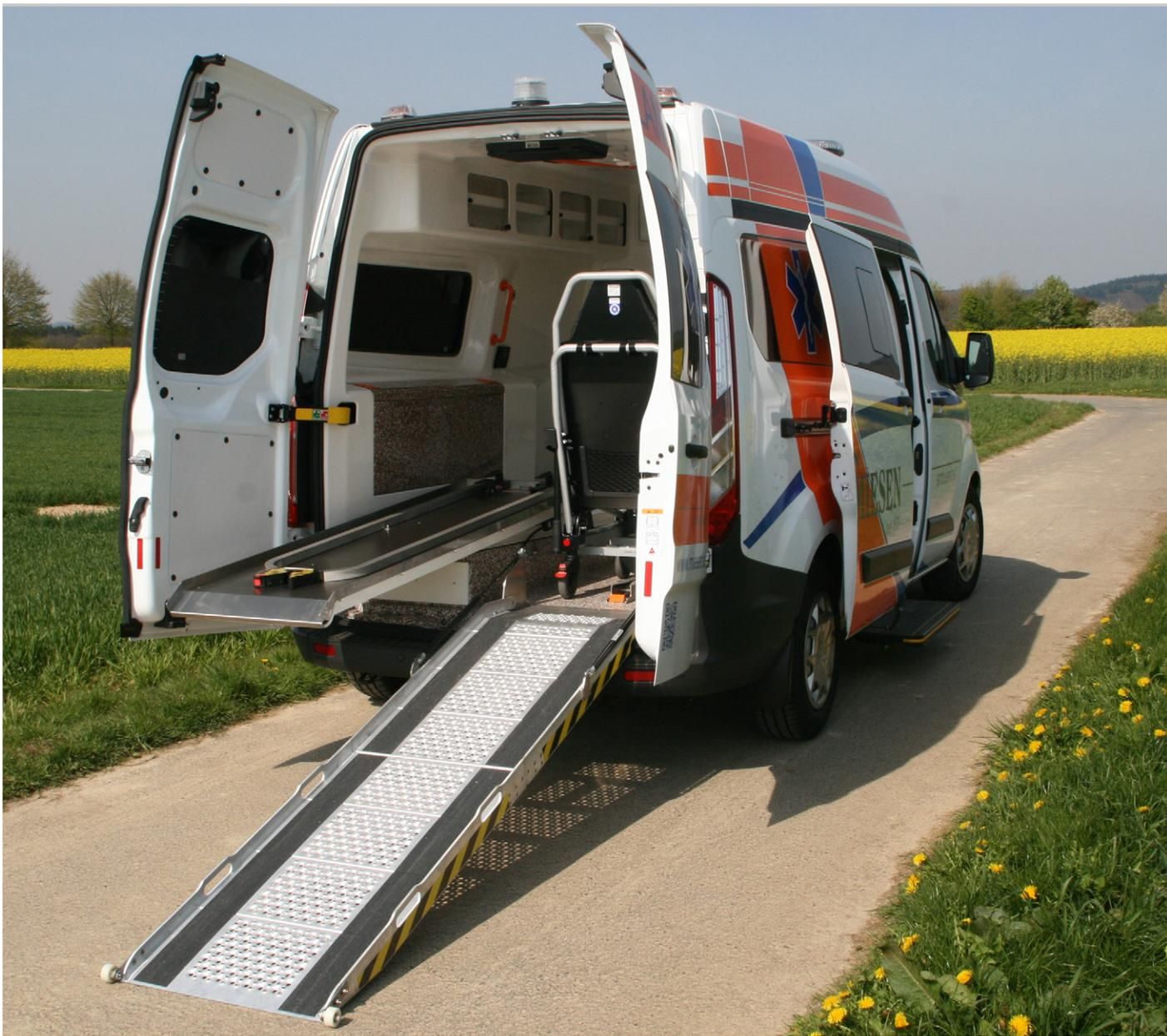
**Praktische Beladehilfen erleichtern das Ein- und Ausfahren des Patiententragestuhls oder eines Rollstuhls und lassen sich mühelos betätigen. Optimal geeignet sind dabei Auffahrampen. Diese werden aufrecht stehend im hinteren Bereich des Fahrzeugs montiert und können manuell ausgeklappt werden. Dabei verdoppelt sich die Länge der Rampe. Das spezielle Lochprofil sorgt für eine rutschfeste Oberfläche.**
