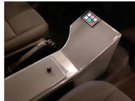
**Eine Mittelkonsole bietet nicht nur zusätzlichen Stauraum, sondern auch die Möglichkeit die Bedieneinheit für die Sondersignalanlage oder die Funkanlage zu montieren.**
