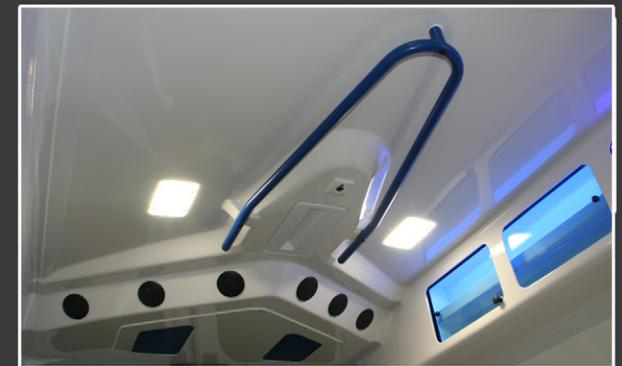
**Eine robuste Haltestange im Bereich der Decke gibt sicheren Halt für die Betreuer.**
