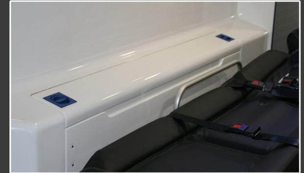
**Schrank zur Aufnahme einer Vakuummatratze an der linken Seitenwand.**
