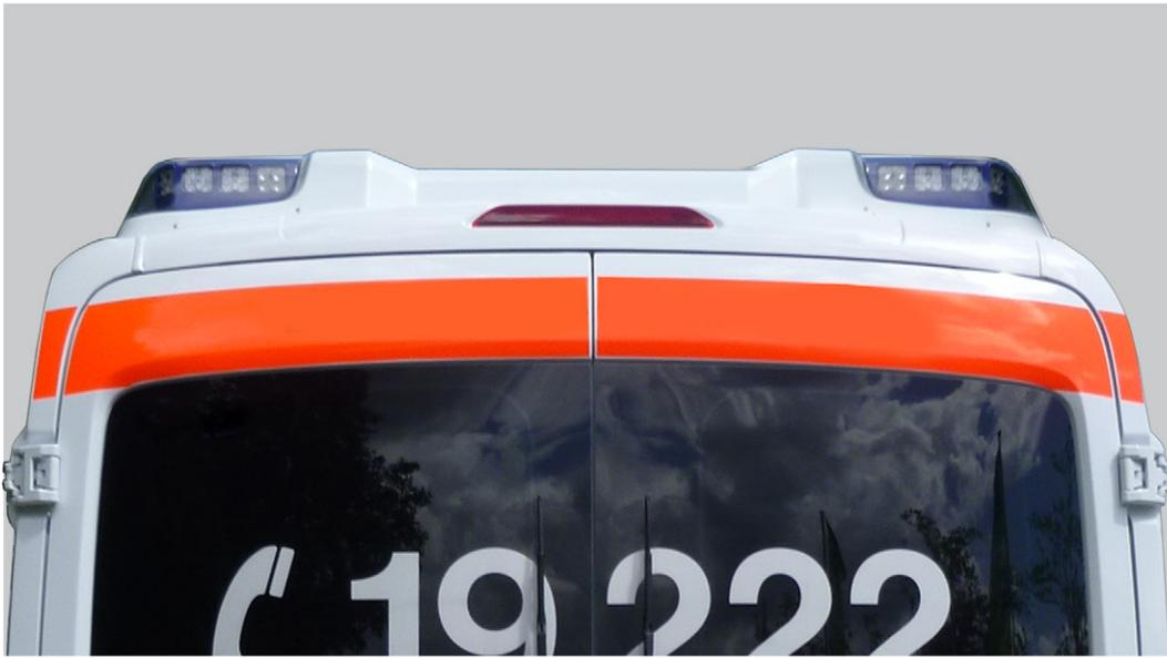
Unsere integrierte Blaulichtanlage bietet eine Vielzahl an Möglichkeiten. Die Form der Warnanlage ist der Fahrzeugkontur angepasst. Das minimiert den Windwiderstand und somit auch die Geräuscentwicklung und den Kraftstoffverbrauch.
