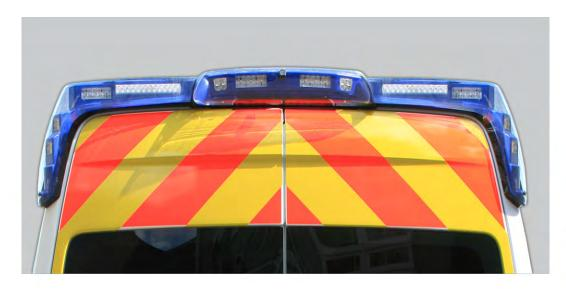
Unsere integrierte Blaulichtanlage bietet eine Vielzahl an Möglichkeiten. Die Form der Warnanlage ist der Fahrzeugkontur angepasst. Das minimiert den Windwiderstand und somit auch die Geräuschentwicklung, sowie den Kraftstoffverbrauch.
