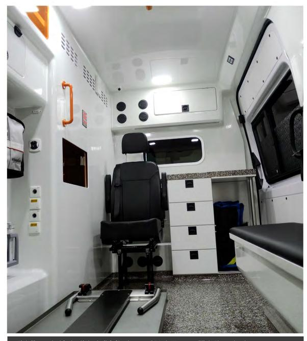
Einteiliger rutschfester Sicherheitsfußboden aus GFK als Wanne seitlich 50 mm hochgezogen. Die Innenbeleuchtung im Patientenraum ist auf Basis hochwertiger LED-Leuchten. Diese sind bei Bedarf dimmbar und auf Traumabeleuchtung umschaltbar.
