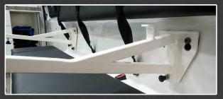
Abnehmbare Halterung über der Sitzbank für eine zusätzliche DIN-Trage mit Schnellverschlüssen
