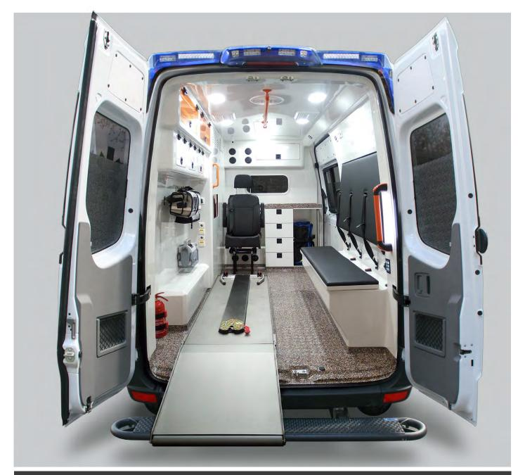
Über eine steckbare Halterung lässt sich eine zusätzliche DIN-Trage zum Transport eines zweiten Patienten an der rechten Seitenwand montieren. Denn im Katastrophenfall müssen oft viele Verletzte zeitgleich behandelt und kürzester Zeit in Sicherheit gebracht werden. Diese lässt sich mit Schnellverschlüssen, mit nur wenigen Handgriffen, einfach montieren!
