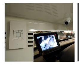
Zur Kommunikation zwischen Fahrerund Patientenraum dient eine eingebaute Gegensprechanlage.
