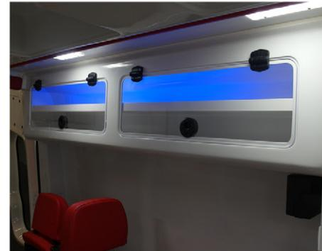
**Im Versorgungscenter befinden sich robuste Haltestangen. Auch die Bedieneinheit für den Schwebetisch ist hier untergebracht. Zusätzliche Fächer dienen u.a. als Halterung für Infusionsbeutel oder Sauerstoffausrüstung.**
