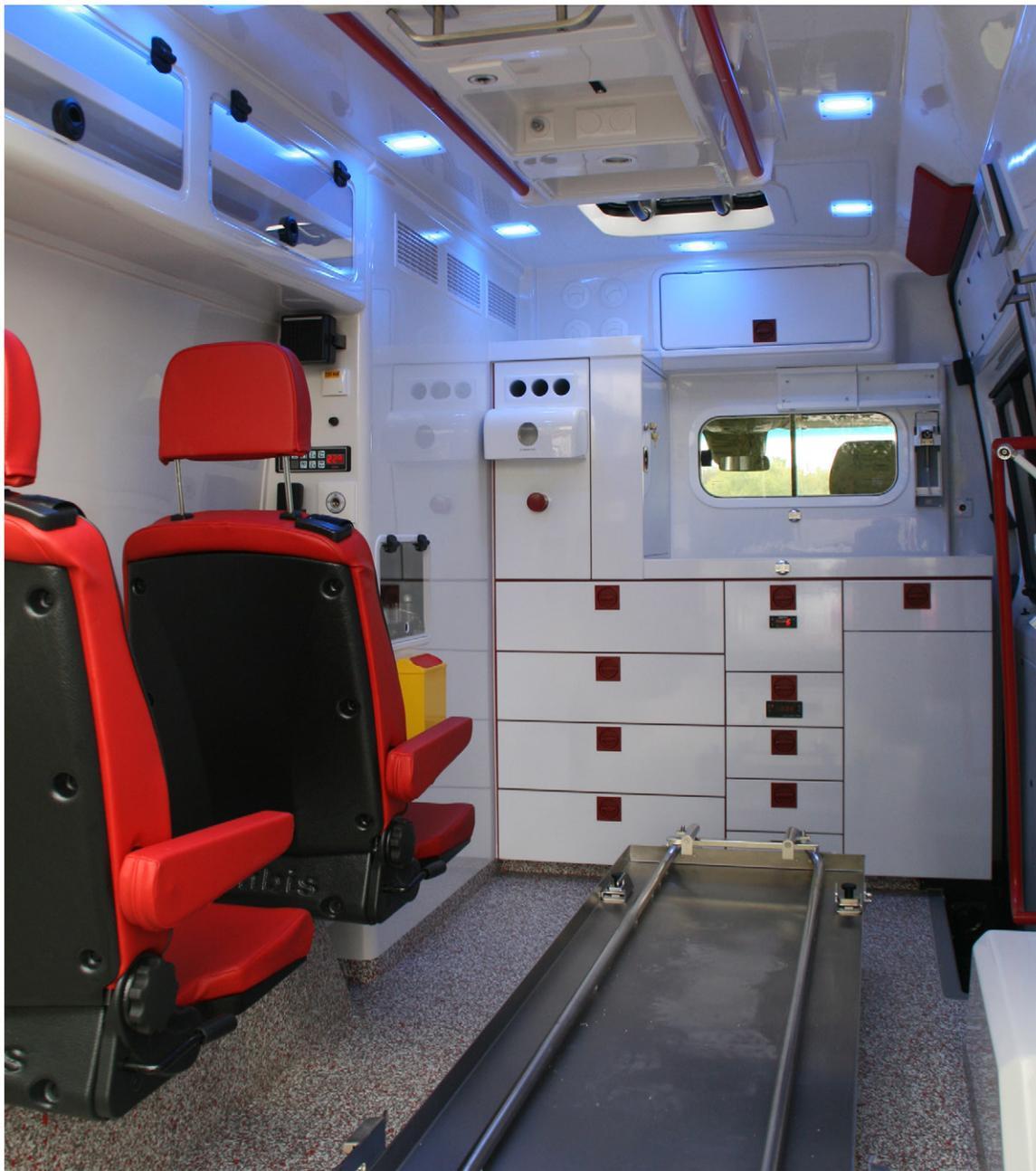
**Der Fußboden im Patientenraum ist rundum als Wanne ausgeführt und seitlich hochgezogen. Die Innenbeleuchtung im Patientenraum ist auf Basis hochwertiger LED-Leuchten. Diese sind bei Bedarf dimmbar und auf Traumabeleuchtung umschaltbar.**
