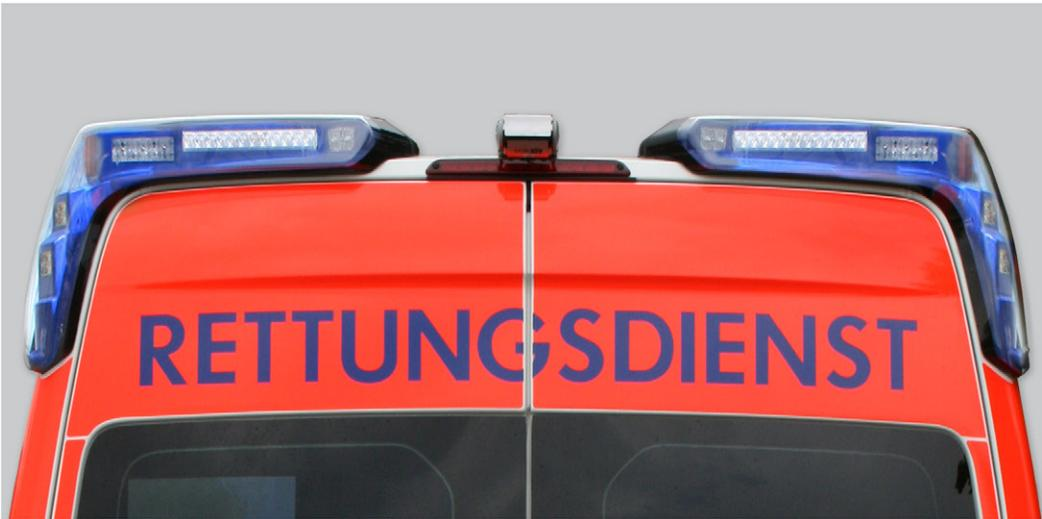
Unsere integrierte Blaulichtanlage bietet eine Vielzahl an Möglichkeiten. Die Form der Warnanlage ist der Fahrzeugkontur angepasst. Das minimiert den Windwiderstand und somit auch die Geräuschentwicklung, sowie den Kraftstoffverbrauch.
